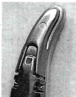
Figure 1/ Abbildung 1: Spring correctly fixed in jaw housing (target state) / Die Feder ist korrekt im Maulteilgehäuse befestigt (Sollzustand)
